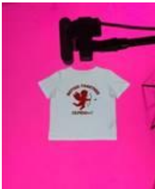
Рисунок 2.3 – Пример расположения веб-камеры над изделием
