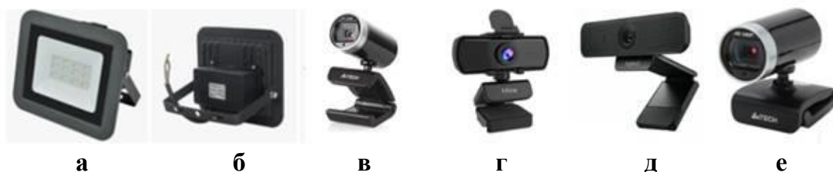
Рисунок 3.2 – Сканирующее и осветительное оборудование ПАК: а) светодиодный прожектор, вид лицевой поверхности; б) светодиодный прожектор, вид задней поверхности; в) - е) модельный ряд веб-камер [221]
