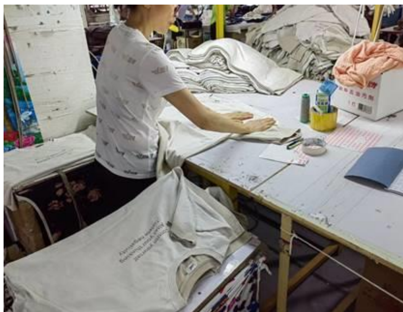
Рисунок 4.10 – Контактный контроль качества продукции. Проверка симметричности
