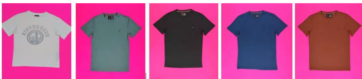
Рисунок 3.16 – Варианты цветовых сочетаний «фон – изделие» для распознавания изображений машинным зрением GarmentScanner
