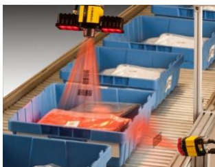
Рисунок 1.4 – Фрагмент установки контроля качества продукции машинным зрением на ПАО «Группа Черкизово» [109]
