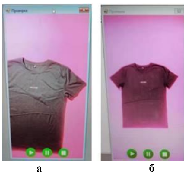
Рисунок 3.6 – Оценка качества визуализации иконки изделия при различной высоте крепления камеры: а) 76 см; б) 96 см
